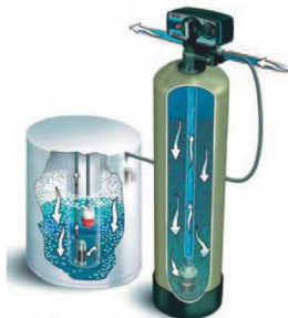
2. ábra Egyoszlopos készülék működési vázlat
